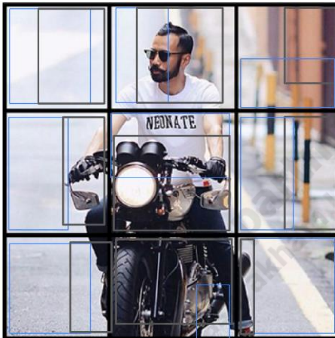
ภาพประกอบที่ 3.38 การแบ่งกลุ่มข้อมูลในแต่ละช่อง โดยแต่ละช่องจะมี 2 anchor
