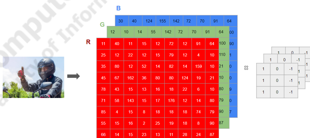
ภาพประกอบที่ 3.15 ตัวอย่างค่าจากรูปภาพสี RGB นำเข้าก่อนทำ Convolution การทำ แบบ R
