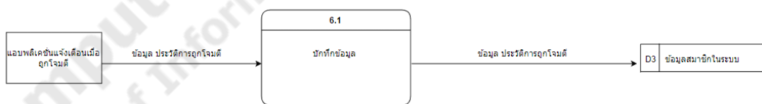
ภาพประกอบที่ 3.9 Data Flow Diagram Level 2 Process บันทึกประวัติการถูกโจมตี
