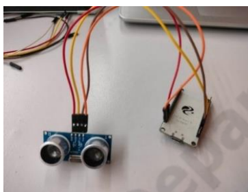
ภาพประกอบที่ 3.16 การต่อ Ultrasonic Sensor Module (HC-SR04)
