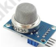
ภาพประกอบที่ 3 MQ-135 Gas Sensor
