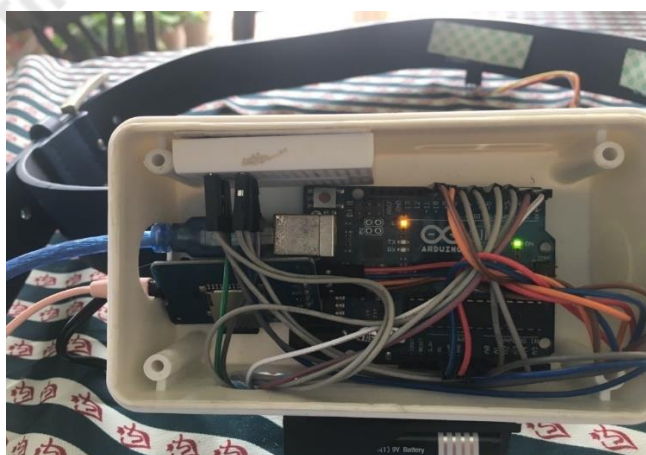
ภาพประกอบที่ 3.6 การเชื่อมต่อวงจรเซนเซอร์กับโมดูลเสียงและบอร์ด arduino
