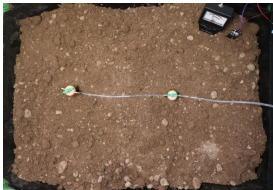
ภาพประกอบที่ 3.30 การทดสอบรดน้ำด้วย Fuzzy Logic
