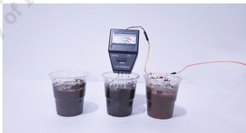
ภาพประกอบที่ 3.25 การวัดผลด้วยเซนเซอร์ NPK meter
