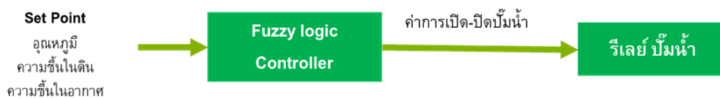
ภาพประกอบที่ 2.41 Block Diagram Fuzzy Logic Controller
