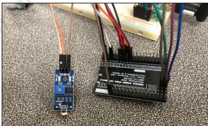
ภาพประกอบที่ 3.9 การต่อเซนเซอร์วัดความสว่างของแสง (LDR Photoresistor)
