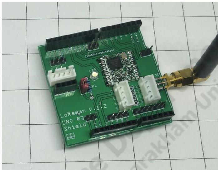
ภาพประกอบที่ 2.12 LoRaWAN Shield V.1.2
