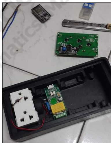
ภาพประกอบที่ 3.12 จัดวางอุปกรณ์ลงในบล็อกยาง
