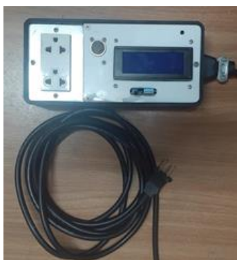
รูปที่ 6 Smart Breaker ในกล่องพร้อมใช้งาน
