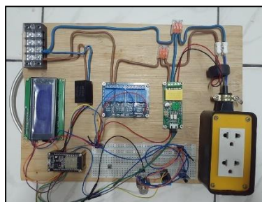
รูปที่ 5 การเชื่อมต่อ Smart Breaker ในบอร์ดทดลอง
