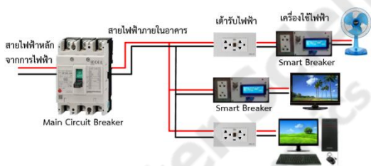
รูปที่ 8 การติดตั้ง Smart Breaker ในอาคาร
